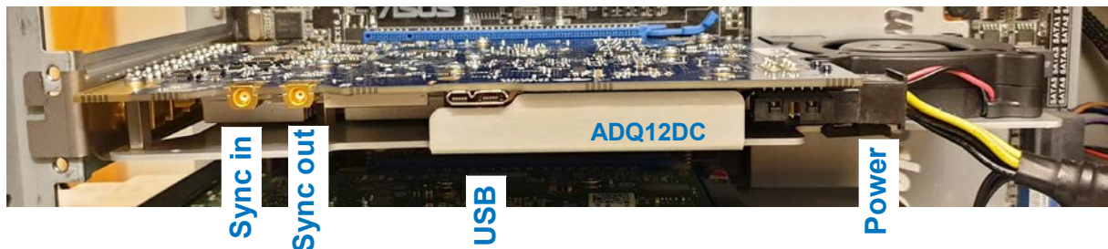
图 8: 安装在 PC 机箱内。注意电源线和同步输入/输出的连接。USB 接口用于固件升级。
