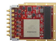
QT7130 1/2/4 通道 10bit-5Gsps 高速ADC卡
