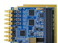
QT7135 1/2/4 通道 16bit-1Gsps 高速ADC卡
