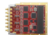
QT7150 4 通道 6bit-250Msps 高速ADC卡
