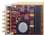
QT7132 1/2 通道 12bit-2.5G/1.25Gsps 高速ADC卡
