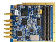
QT7332 2 通道 1通道 12bit-4Gsps 高速 ADC 1通道 14bit-2.8Gsps 高速DAC
