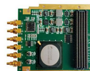
QT7133 1/2 通道 12bit-3.6G/1.8Gsps 高速ADC卡
